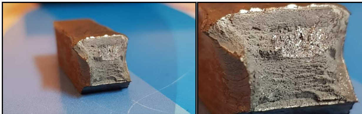
Figure (III-4) : Faciès de rupture de l'éprouvette chauffée à 250°C.
