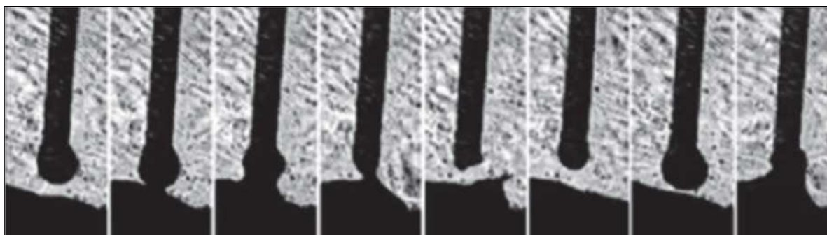
Figure (I-10): Transfert par court-circuit. [5]
