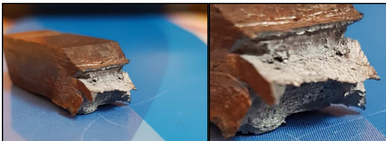
Figure (III-6) : Faciès de rupture pour l'éprouvette chauffée à 450°C.
