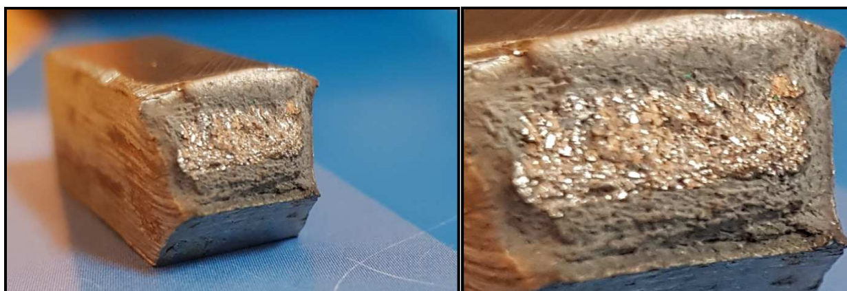
Figure (III-3) : Faciès de rupture de l'éprouvette non traitée.
