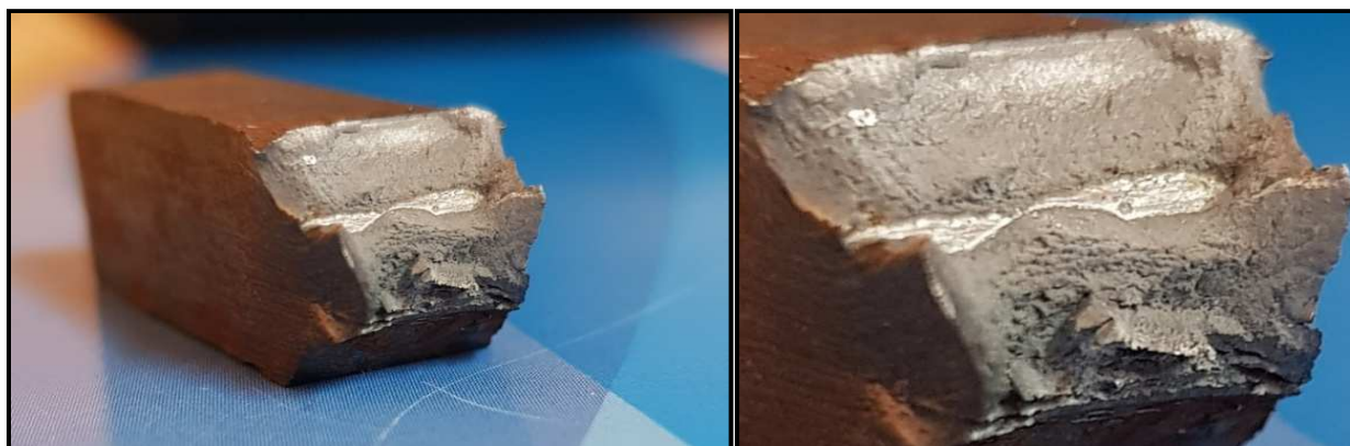
Figure (III-5) : Faciès de rupture a l'éprouvette chauffée à 350°C.
