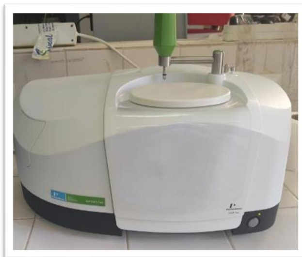
Figure II.9 Spectromètre infrarouge de type Prekin Elme two (Laboratoire de physique des matériaux et catalyse, Université de Bejaia).
