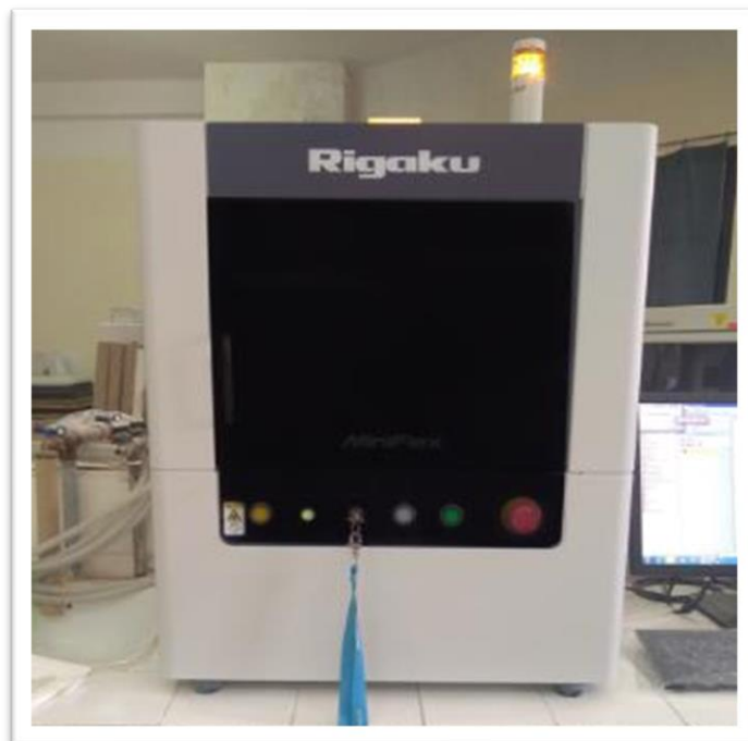
Figure II.8 Diffractomètre de rayons X de type Rigaku Mini flex-II diffractometer (Laboratoire de physique des matériaux et catalyse, Université de Bejaia).
