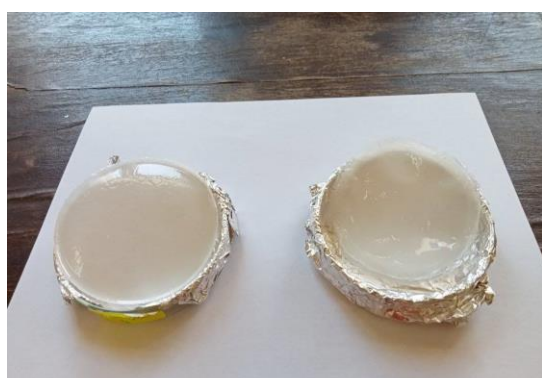
Figure II.7 (a) Différentes étapes de synthèse des films nanocomposites YPO_4 : Pr^{3+} /Ps, (b) Films nanocomposites YPO_4 : Pr^{3+} /Ps.
