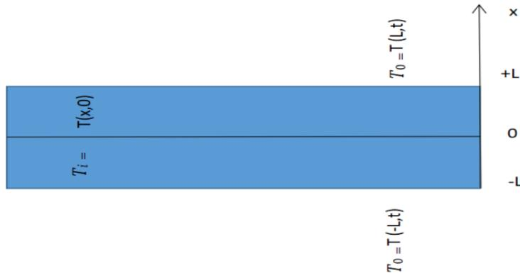
FIG. 1.15 – Schéma d'une plaque infinie.
