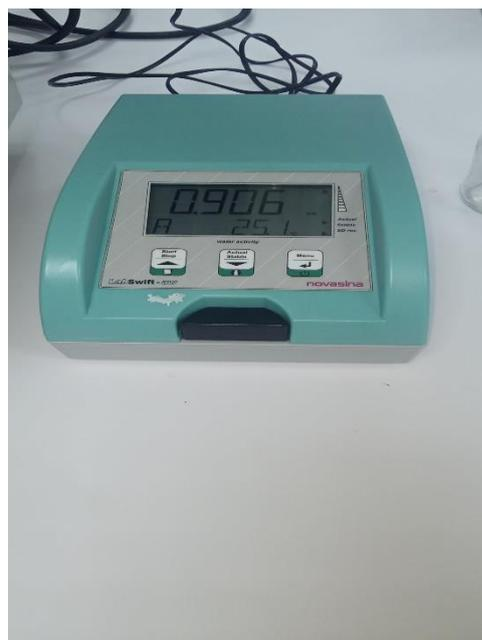
**Figure 19:** photographie d'un AWmètre.
