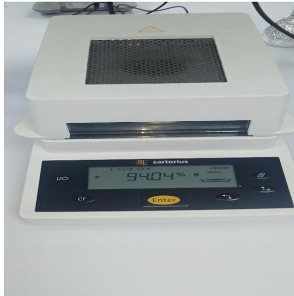
**Figure 20:** photographie d'un dessiccateur.
