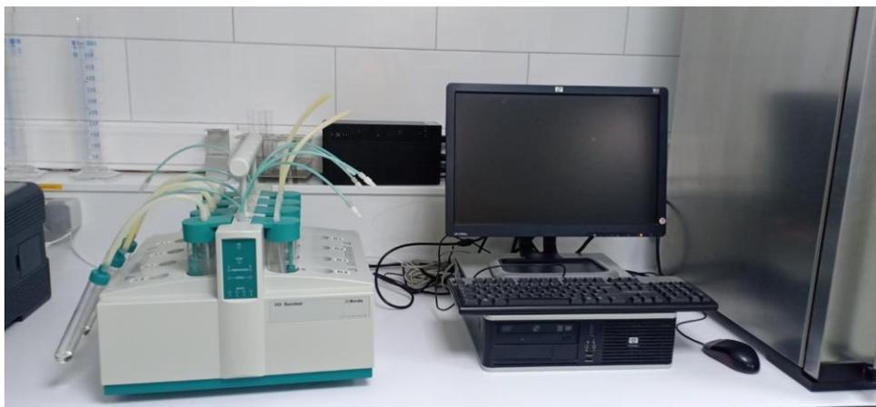
**Figure 22:** photographie d'un RANCIMAT (Metrohm, modèle 743).
