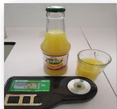
Fig.06 : Mesure du Brix pour la ligne RB
