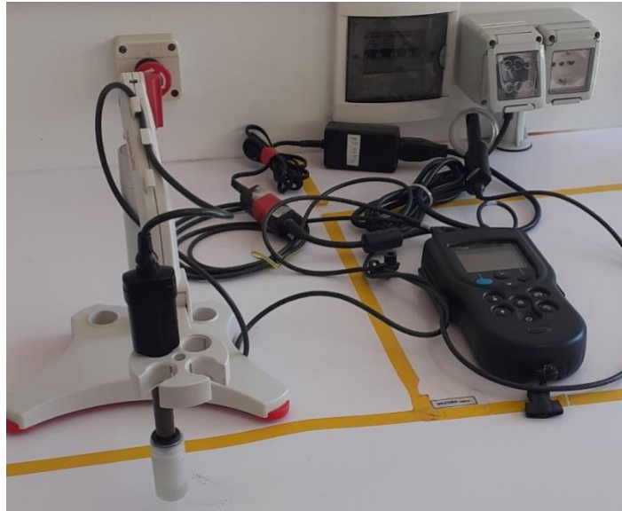
Figure 2 : pH mètre (Marque HACH) utilisé pour la mesure du pH
