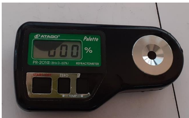
Figure 4: Refractomètre(ATAGO) utilisé pour la mesure de °Brix.
