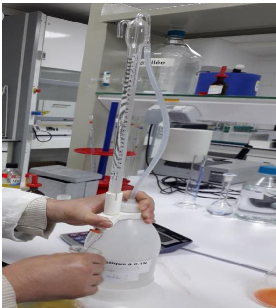
Figure 3 : Détermination de l'acidité titrable par une burette graduée.
