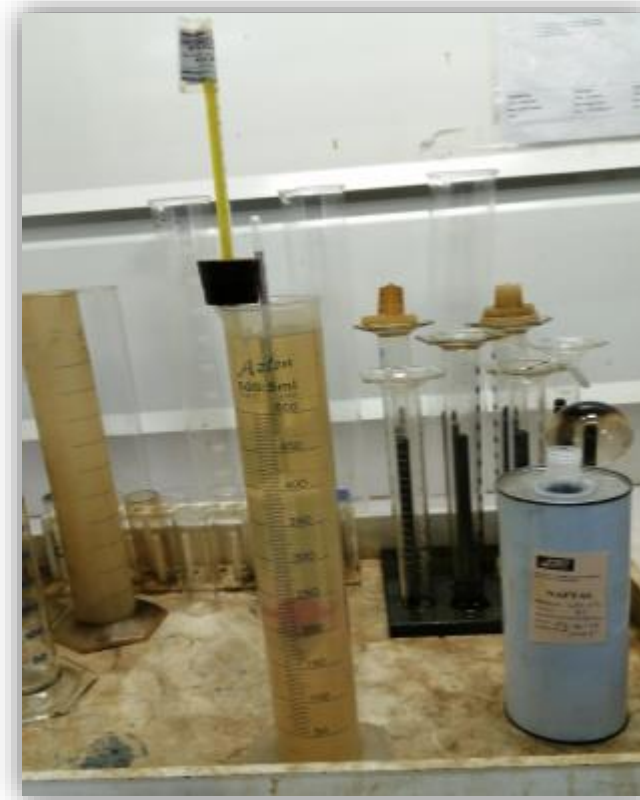
Figure III.2 : Lecture de la densité utilisant l'aréomètre.
