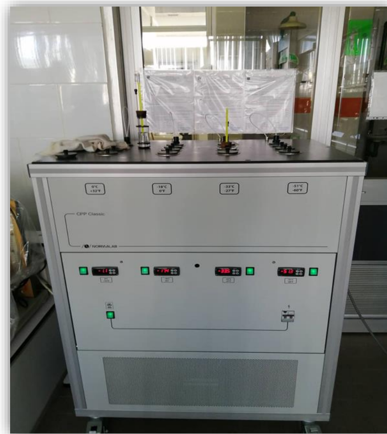
Figure III.7 : Appareillage de détermination de point d'écoulement par la méthode d'essai ASTM D 97.
