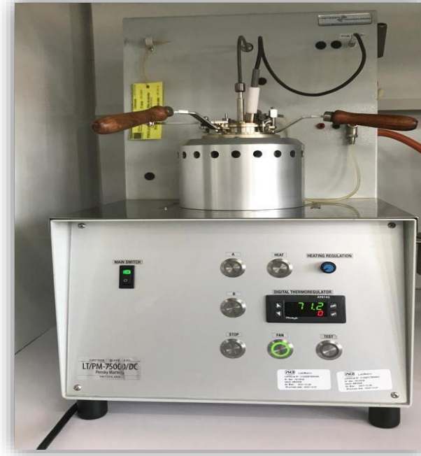
Figure III.5: Appareil de mesure du point d'éclair automatique vase close FLASH POINT TESTER HFP 339.
