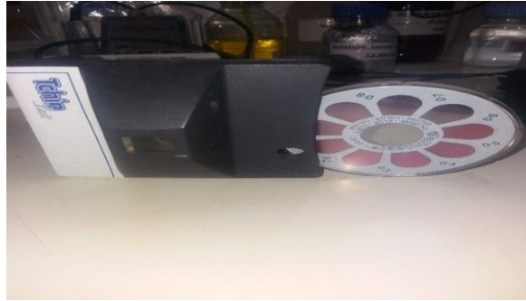
Figure 15 : Photographie de l'appareil de Colorimètre.
