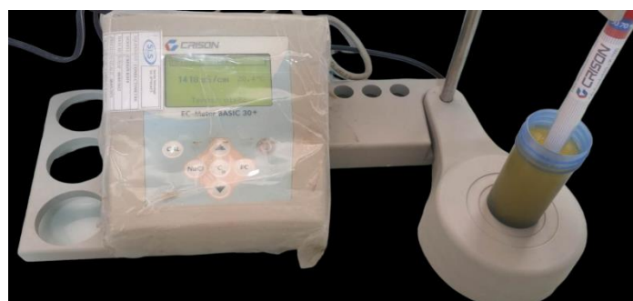
Figure 6 : conductimètre (CRISON de l'Espagne) utilisé pour mesurer la conductivité
