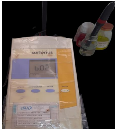
Figure 5 : pH-mètre (sartorius de l'Allemagne) utilisé pour la mesure du pH
