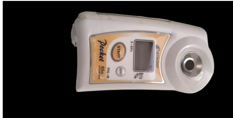
Figure 8 : Réfractomètre (ATAGO de la Chine) utilisé pour la mesure du Brix
