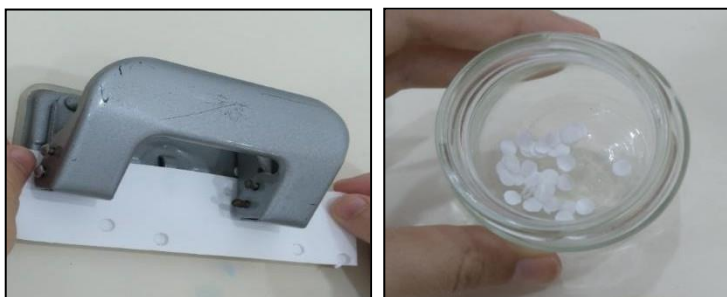
Figure n° 08. Réalisation des disques de papier Whatman n° 3.
