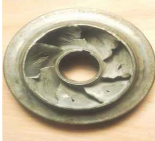
Figure (IV.5) : Principe de la cavitation [2]
