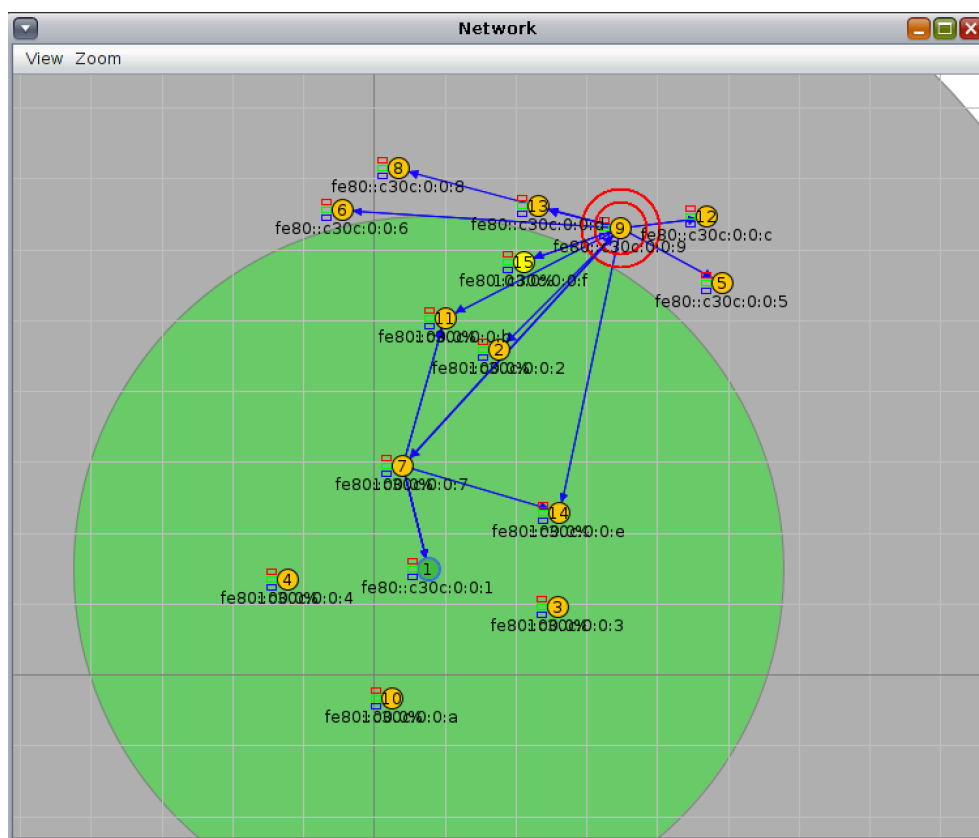
FIG. 4.7 : La topologie de l'attaque blackhole.
