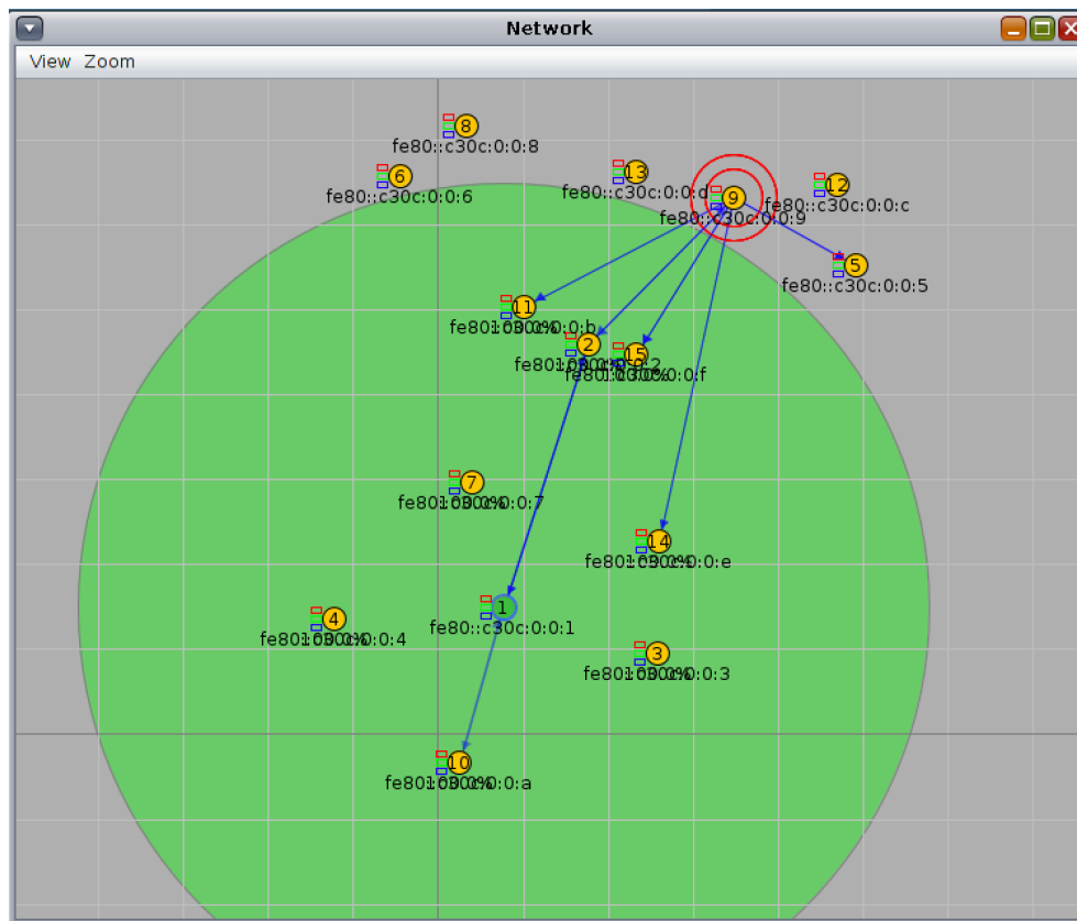
FIG. 4.4 : La topologie de la simulation sans noeud malicieux.
