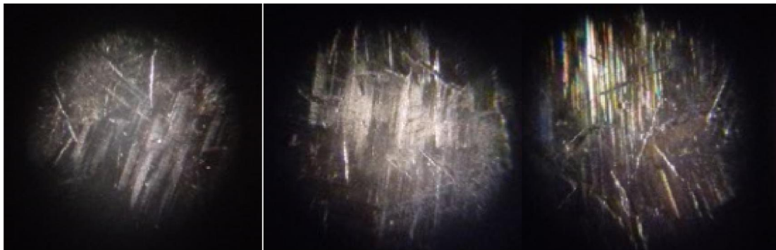
Figure III.9 : faciès d'usure de l'échantillon molybdène après usure à une vitesse de glissement de 1 m/s à différentes charge dans un régime sec.
