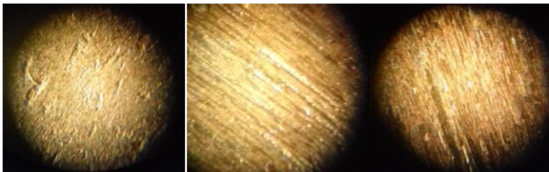
Figure III.8: faciès d'usure de l'échantillon molybdène après usure à une vitesse de glissement de 0.5m/s à différentes charge dans un régime lubrifié.
