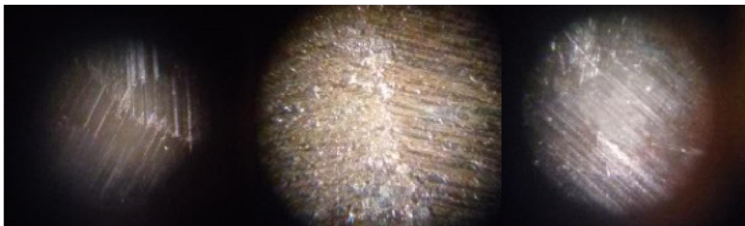
Figure III.3 faciès d'usure de l'échantillon acier après usure à une vitesse de glissement de 0.5m/s à différentes charge dans un régime lubrifié.
