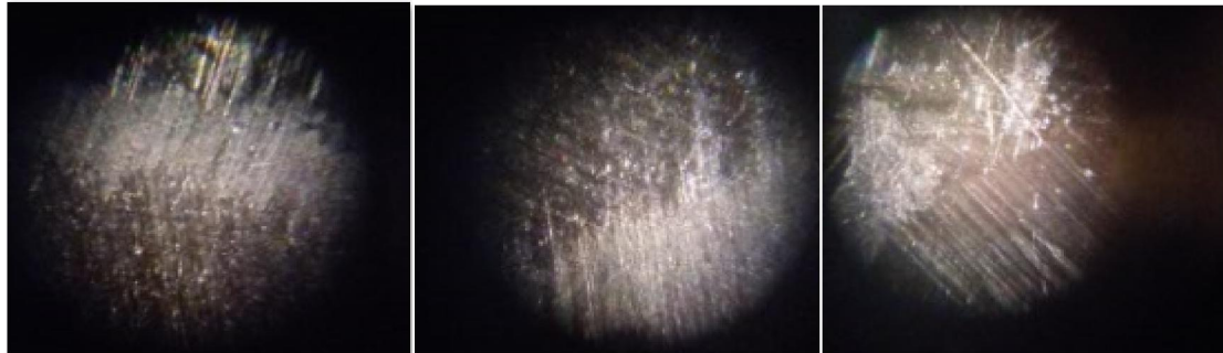
Figure III.2 faciès d'usure de l'échantillon acier après usure a une vitesse de glissement de 0.5m/s à différentes charge dans un régime sec.
