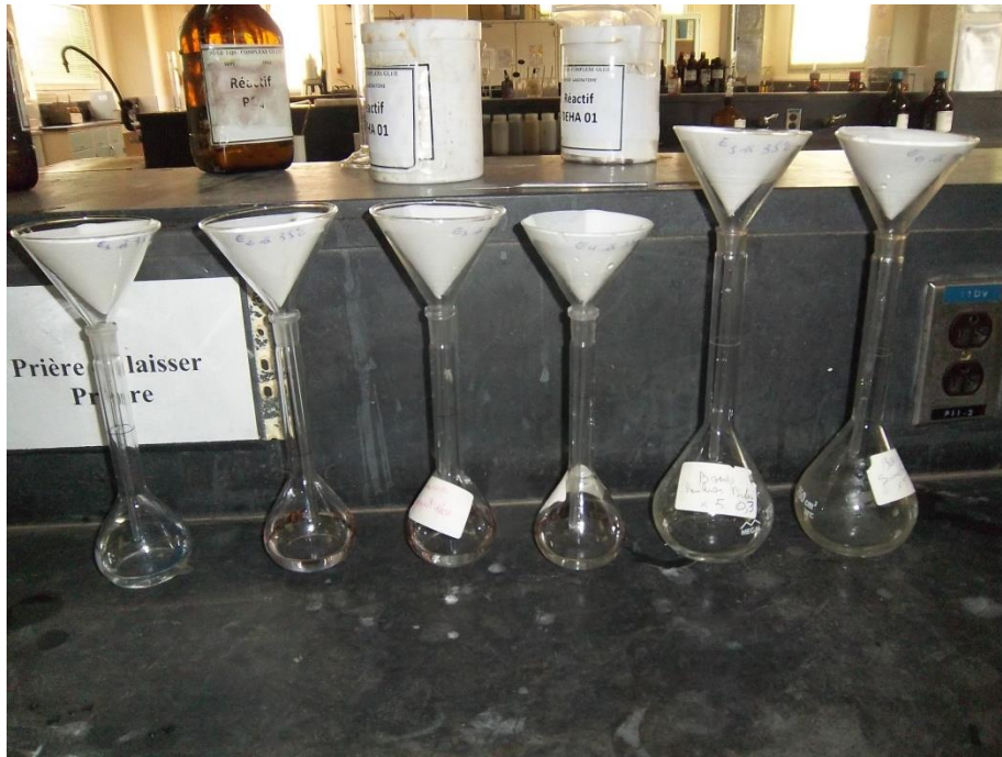
Figure III-7 : Séparation solide-liquide par filtration
