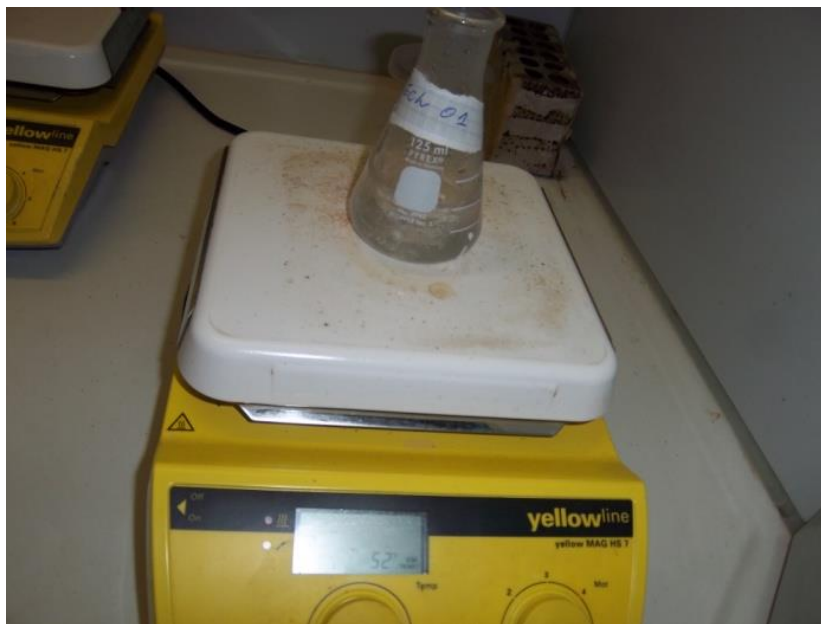
Figure III -4 : Dispositif de l'essai de coagulation floculation pour récupération du phosphate
