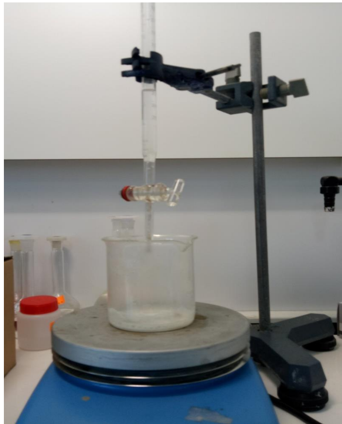
Figure III-6 : Essai de l'attaque du phosphate par acide sulfurique
