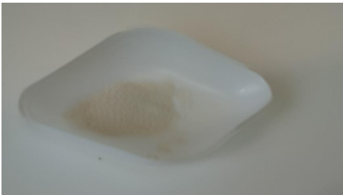
Figure IV-8 : Echantillon du phosphate de calcium récupéré
