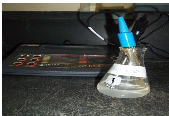
Figure III-1 : Mesure du pH des échantillons
