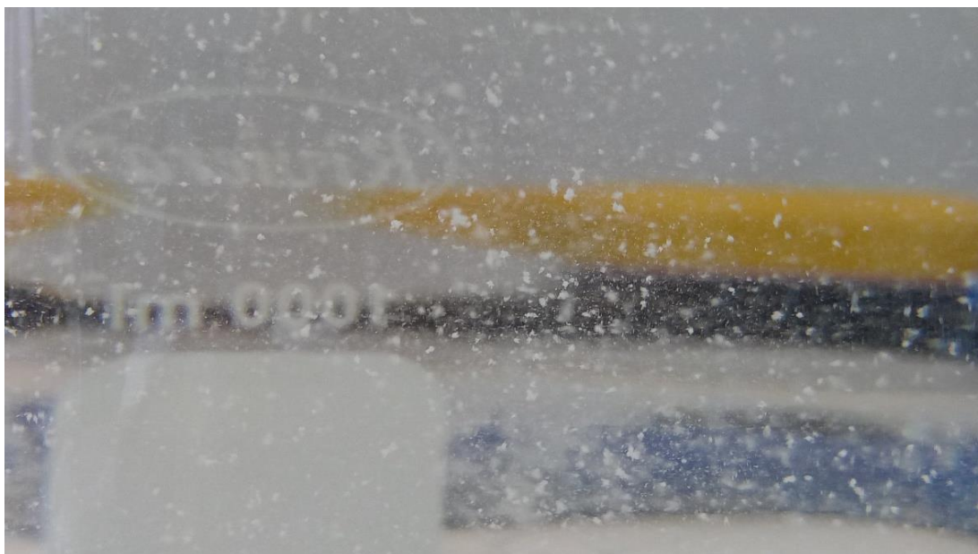
Figure IV-3 : Formation des floccs lors l'agitation lente
