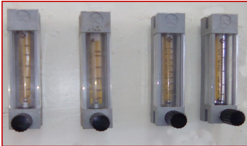
Figure III.9 : Débitmètres à air placés en parallèle
