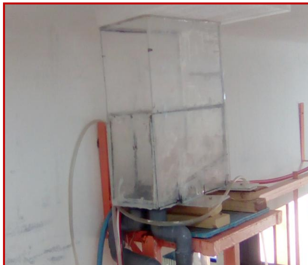
Figure III.7: Séparateur de phases
