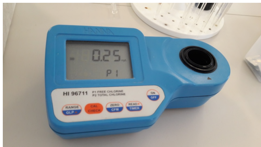
Figure III.14 : Appareil de mesure de chlore libre (Mars 2017)
