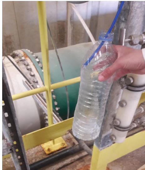
Figure III.10 : Point de prélèvement de l'eau rejetée (saumure) [Photo prise au niveau de la station de dessalement de Ténès 2017].
