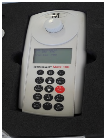
Figure III.12: Turbidimètre de la station de Ténès. ([Photo prise au niveau de la station de dessalement de Ténès 2017])
