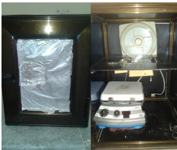
Figure II.5 : Image d'une cellule à photocatalyse utilisée.
