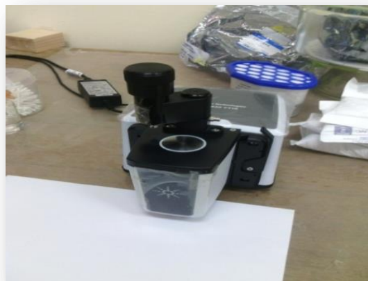
Figure II.13. Image montrant l'appareillage de spectrophotomètre infrarouge à transformé de Fourier (FT-IR).
