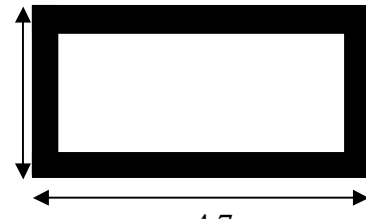
Figure III.15 : Dalle sur quatre appuis
