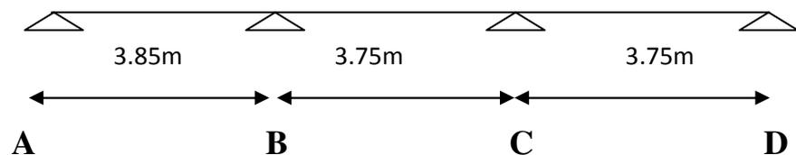
**Figure III.8:** : schéma statique d'une poutrelle type2
