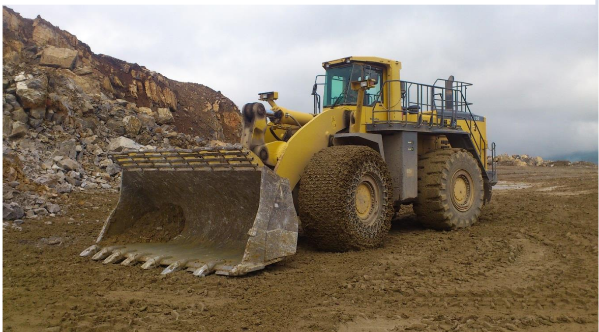
Annexe 16 : chargeuse de type ‘Komatsu WA 700’ utilisé à la carrière d’Ain el kebira
