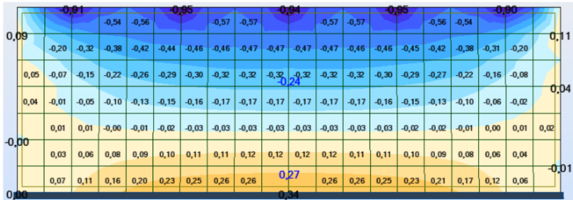
FIGURE 5.46 – Cartographie des moments selon l'axe xx Dans le voile intermédiaire (Réservoir vide sans poussées de terres à l'ELS).
