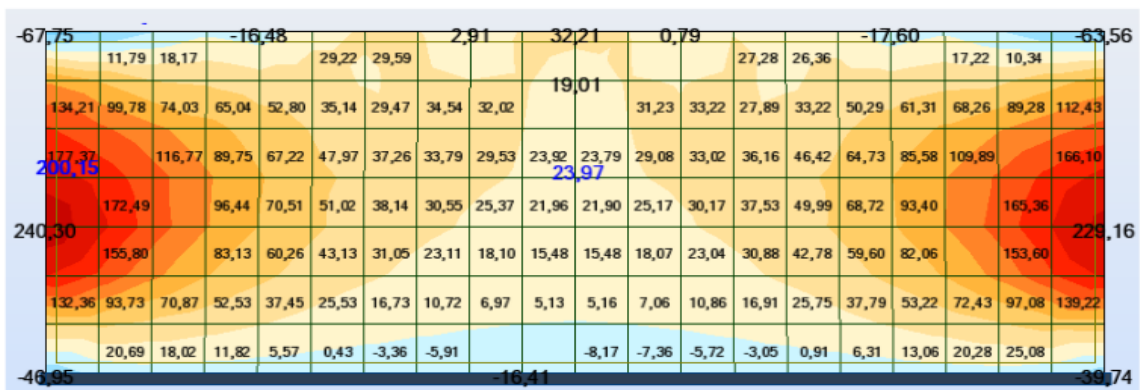
FIGURE 5.57 – Cartographie des efforts de membrane Nyy Dans le voile intermédiaire (Réservoir plein sans poussées de terres à l'ELS).
