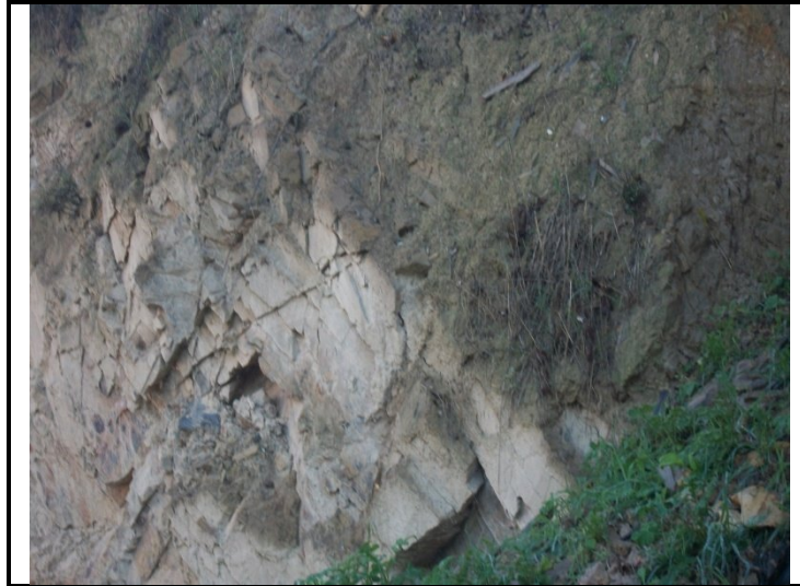
Photo .VI.13 : Affleurement du substratum marneux surmonté d'une couverture argilo-graveleuse(PK 05+100).
