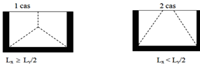
Figure III.17 : Ouverture des fissures
