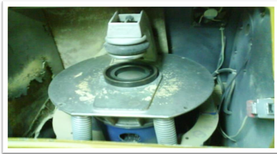
Figure III.7: Broyeur pulvérisateur LM2. [Source : photo prise]
