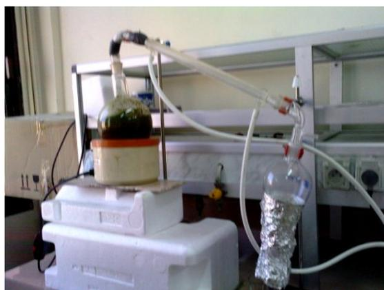
**Figure 8 :** Montage d'hydrodistillation de Clevenger modifié
