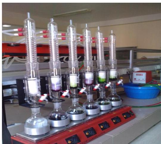
**Figure 9:** Elaboration d'extraits éthanoliques par l'appareil de Soxhlet
