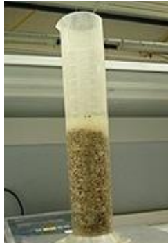
Figure IV.5 : Mesure de la masse volumique absolue.
