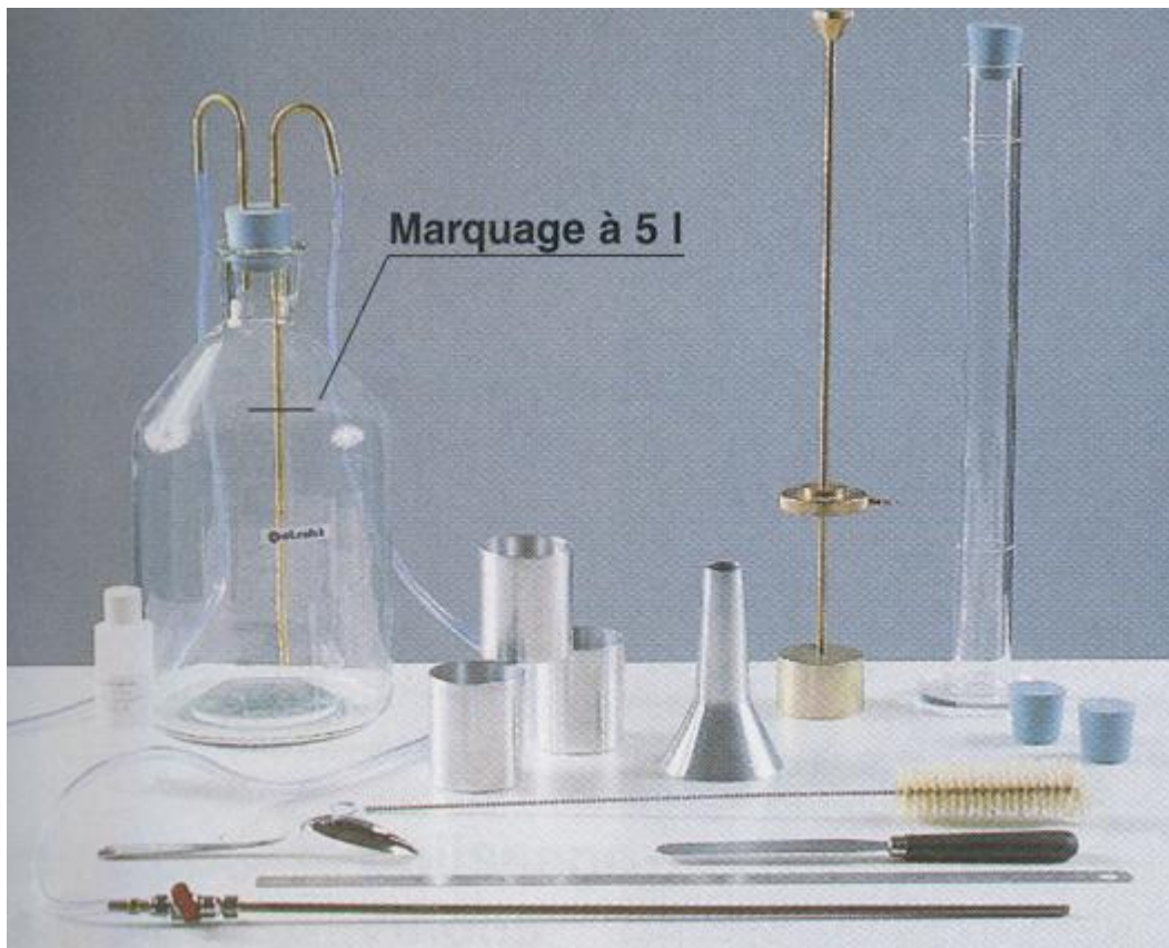
Figure IV.6 : Matériels utilisés pour l'essai d'équivalent de sable.
