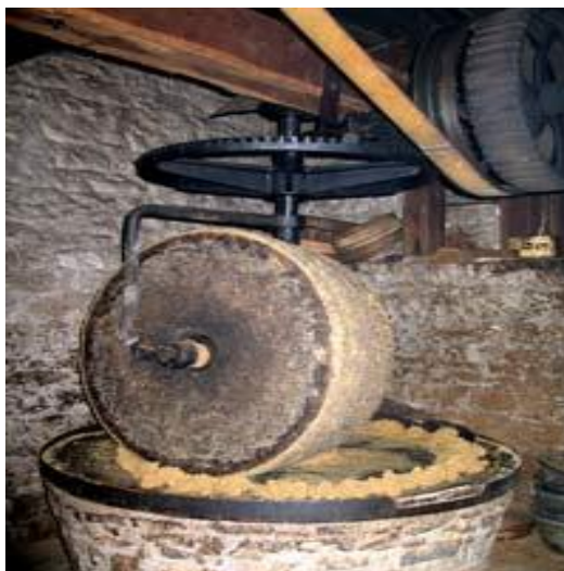
Figure III.11 : L'extraction de l'huile de fruits et pépins à l'aide de meules
