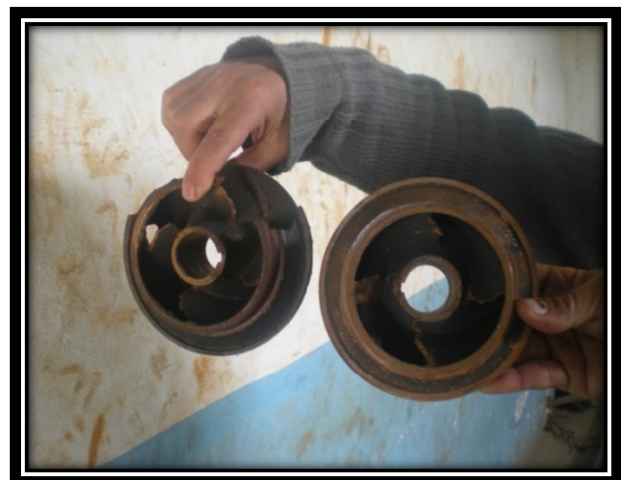
Photo 2: phénomène de corrosion des turbines.
