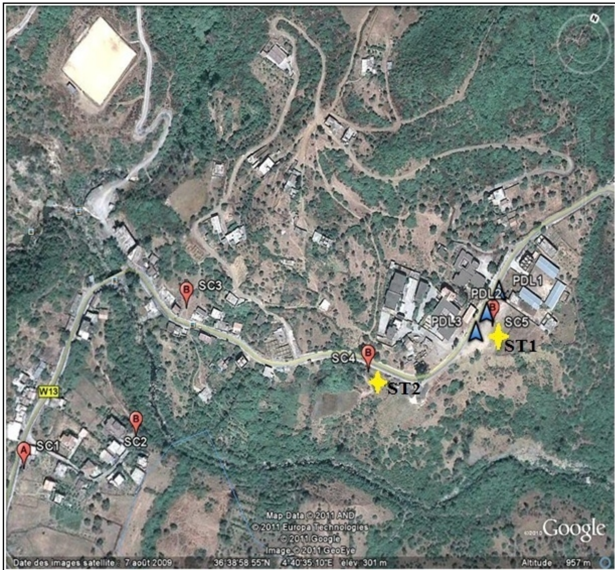
SC : sondage carotté. PDL : pénétromètre dynamique lourd. ST : station topographique.
