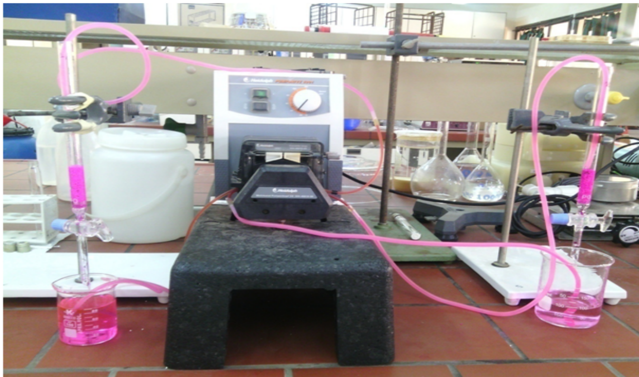
FIGURE 2.6 – Montage utilisé pour l'extraction et la régénération de la Rhodamine B par les microsphères.
