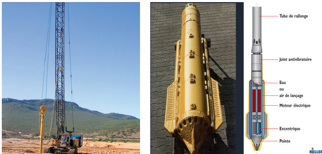
Figure (I-39) : Vibreur KELLER
