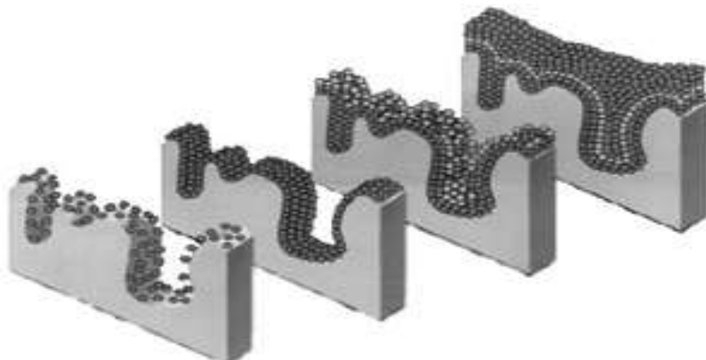
Figure I.4 représentation des étapes de l'adsorption de l'adsorbât à la surface d'un adsorbant. [17]
