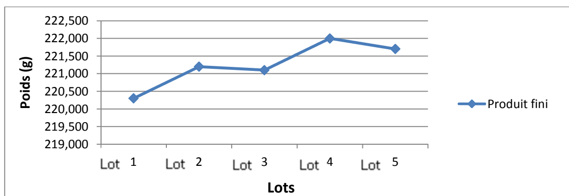
Figure 14 : Évolution du poids des briques du produit fini dans les cinq lots.
