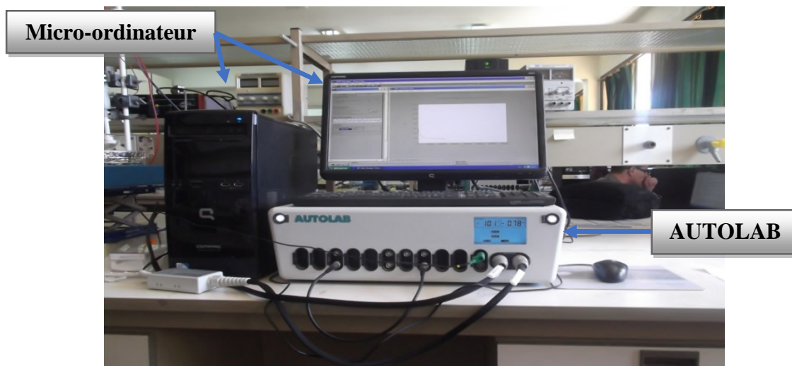
Figure II.2: Dispositif expérimental de mesure électrochimique.
