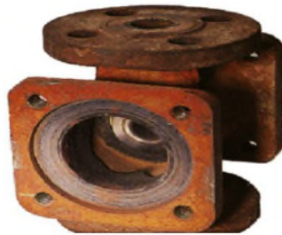
Figure I.1. Corrosion générale (rouille) d'une pièce en acier [12].
