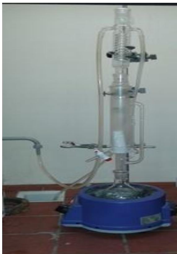
Figure IV.3 : Dispositif expérimental de l'extraction Soxhlet
