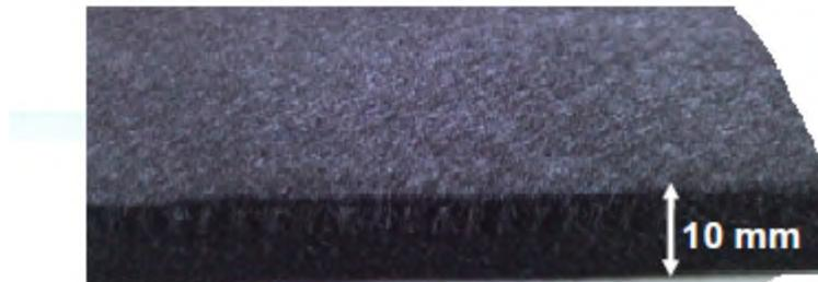
**Figure III.2 :** Feutre de carbone
