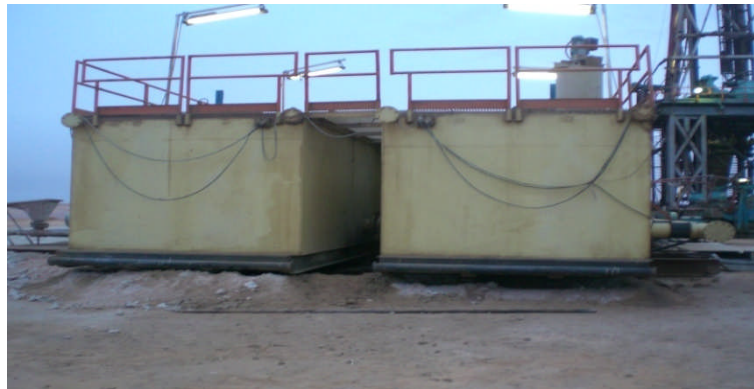
Figure I.1 : Bassin à boue.
