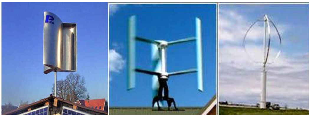
Figure (I.4) éoliennes à axe vertical (de gauche à droite) : turbine savonius, turbine Darrieus
