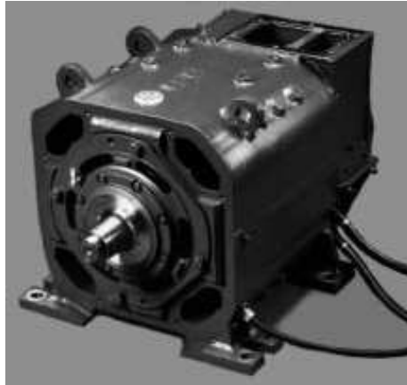
Figure III. 2 : Moteur GE752 à excitation séparée
