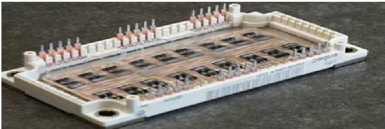
Figure (I-16) : Convertisseur matriciel dans un module [6].
