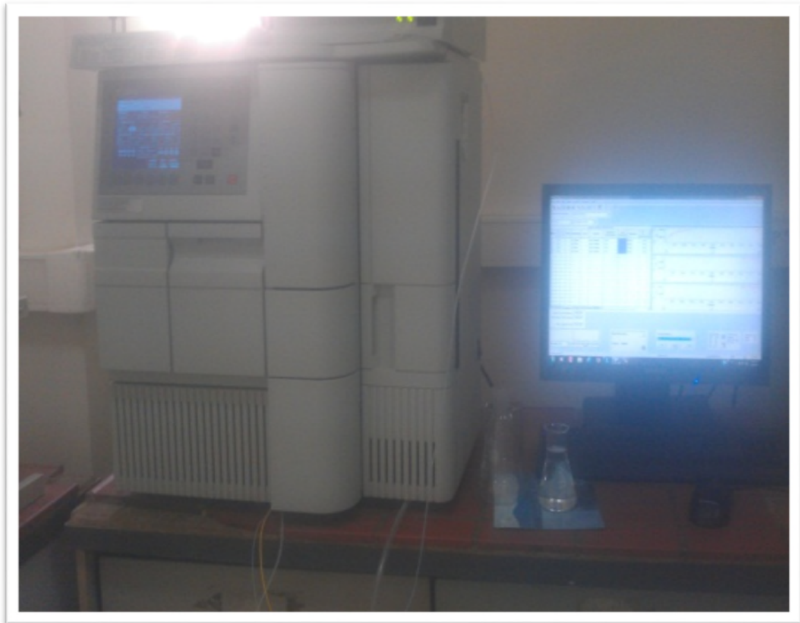
Figure 9 : Appareil HPLC de marque «WATERS e2695» avec un détecteur photodiode de marque « WATERS 2998 »
