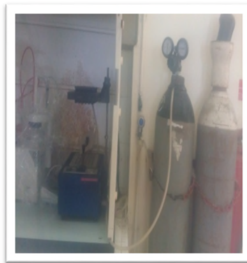
Figure 8 : dispositif de barbotage avec l'azote
