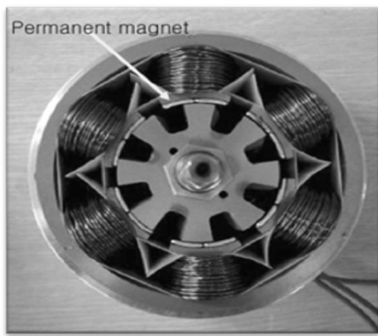
a: Générateur triphasée FRM 6/8 [8]
