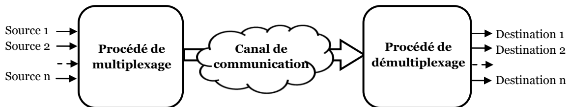
Figure III. 1 : Procédé de multiplexage/Démultiplexage pour la cohabitation de plusieurs trafics sur le même médium partagé.
