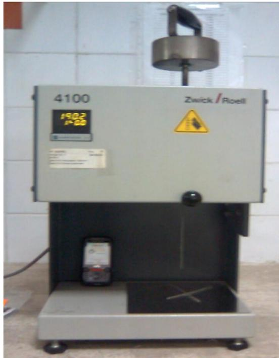
**Fig.10:** Vue d'ensemble de l'appareil de mesure de l'IF.
