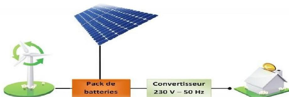
**Figure I.1** Schéma électrique simplifié d'un système hybride solaire/éolien autonome
