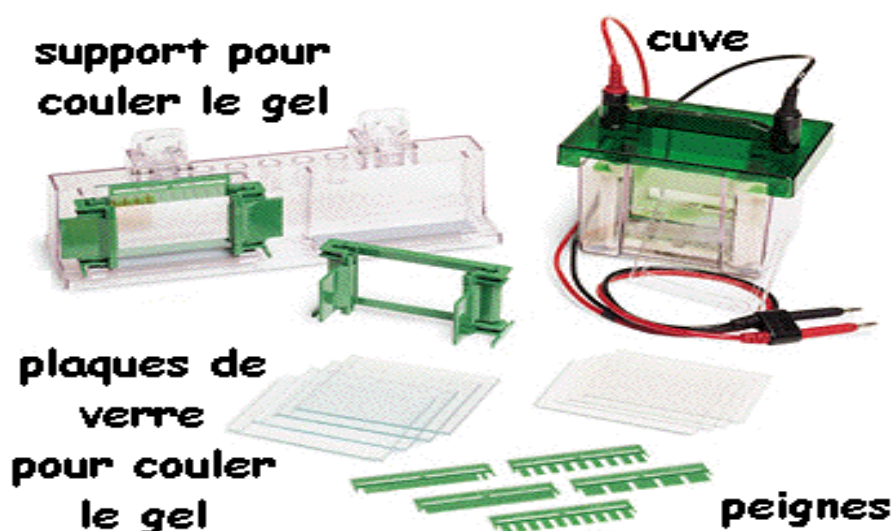
Fig. 08: Cuve et accessoires du dispositif d'électrophorèse (Mini Protean II, BIORAD).
