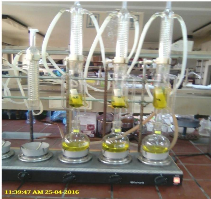
**Figure 21:** Extraction des matières grasses par soxhlet
