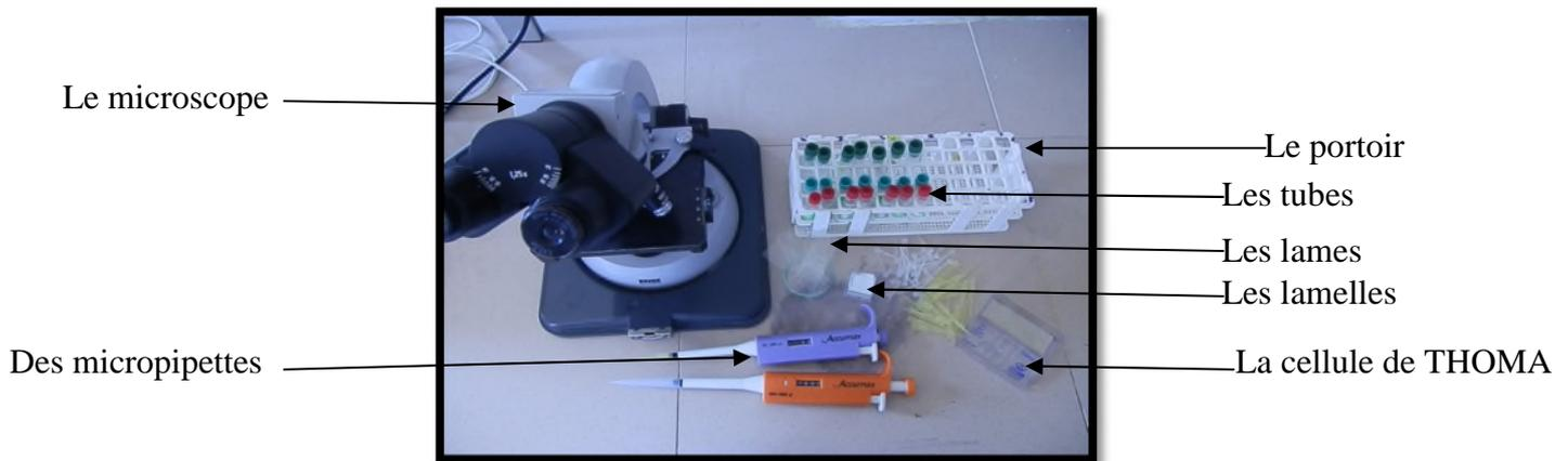
**Figure 23:** Matériel nécessaire pour l'analyse microscopique
