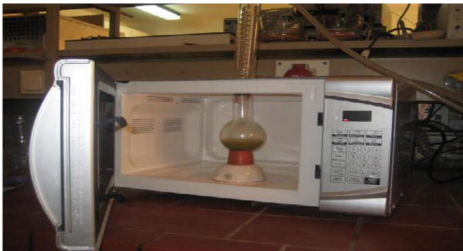
**Figure 14 :** Prototype utilisé pour l'extraction assistée par microondes
