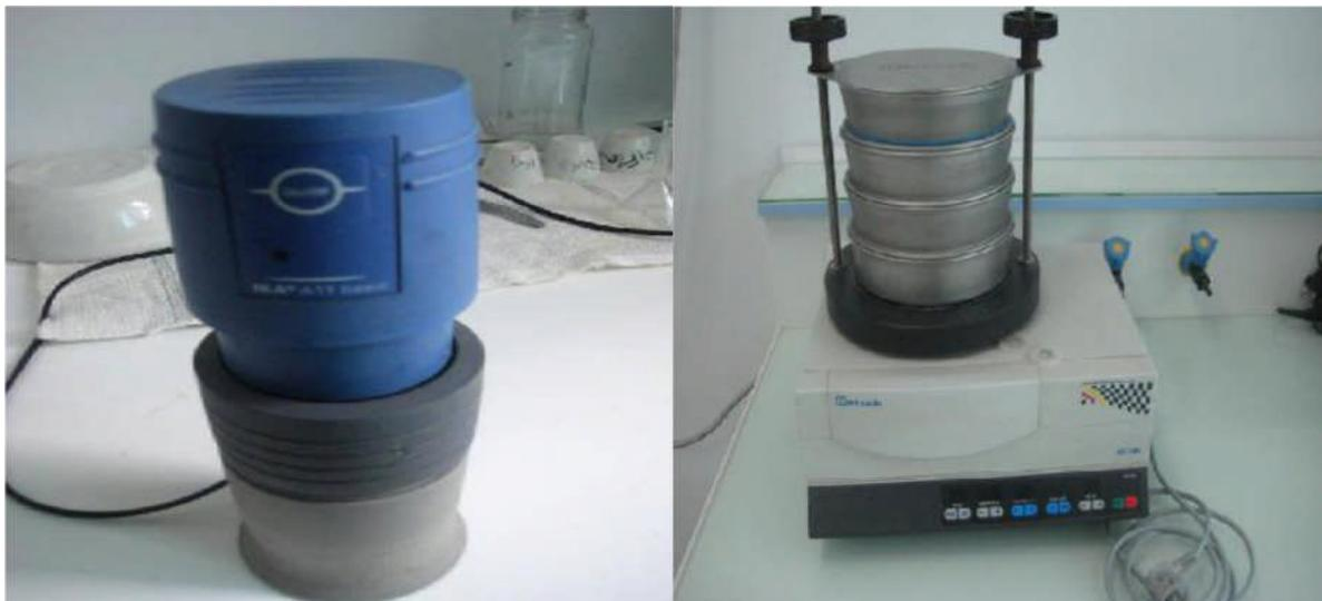
**Figure 12 :** Photographie du broyeur et tamiseur automatique.
