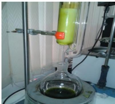
**Figure 11** : Extraction de la matière grasse par soxhlet.
